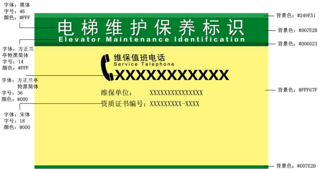
图B.5 电梯维护保养标识样式（维护保养单位信息部分）样式
