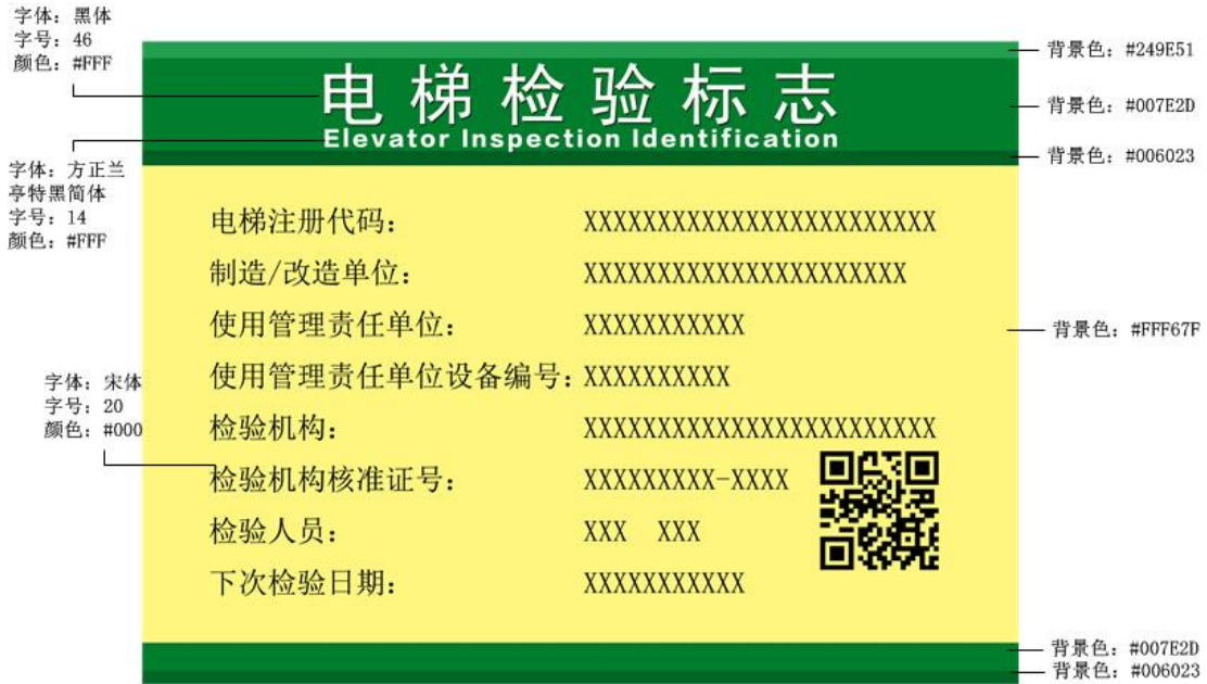
图B.9 电梯检验标志样式
